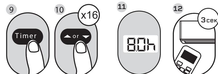
Например: установка таймера на включение через шесть часов работы, рабочее время два часа и затем автоматическое выключение.
