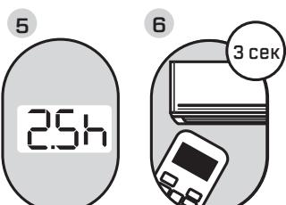
**Пример:** установка таймера на включение блока через 2,5 часа.
