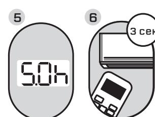
**Пример:** установка таймера на отключение блока через 5 часов.
