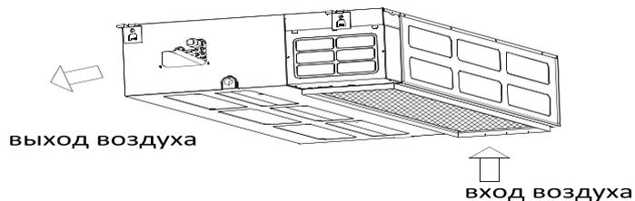
Отвинтить саморезы и демонтировать пластину и фильтр, отвинтить саморезы и демонтировать заднюю часть.
