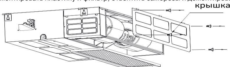
Установить пластину и фильтр на обратной стороне, установить крышку внизу возврат воздуха. Закрутите саморезы обратно.
